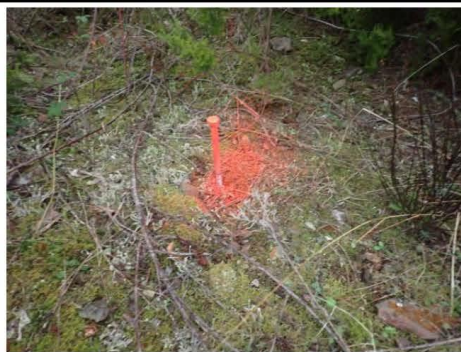
Illustration 30 : Mèche métallique installée, point de repère fixe de mesure du fontis
