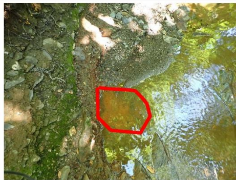
Illustration 7 : Précipités orange dans le cours du ruisseau à l'aplomb du DMA
